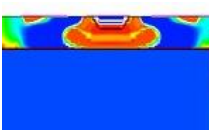
Рисунок 1.10 – Расчет теплового сопротивления в канале СИТ [26]
