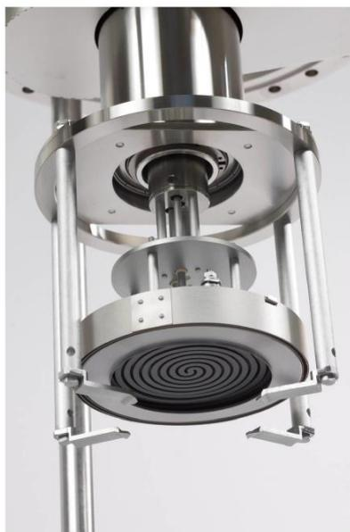
Рисунок 13 – Фотография нагревательного узла установки  $\text{NH}_3$ -МВЕ Compact-21N
