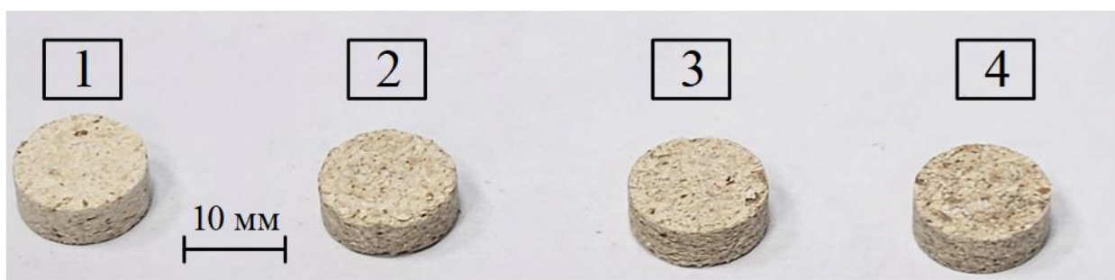
Рисунок 2.2 – Внешний вид пеллет: (1) 100% опилки; (2) 95% опилки, 5% картон; (3) 90% опилки, 10% картон; (4) 85% опилки, 15% картон [233]
