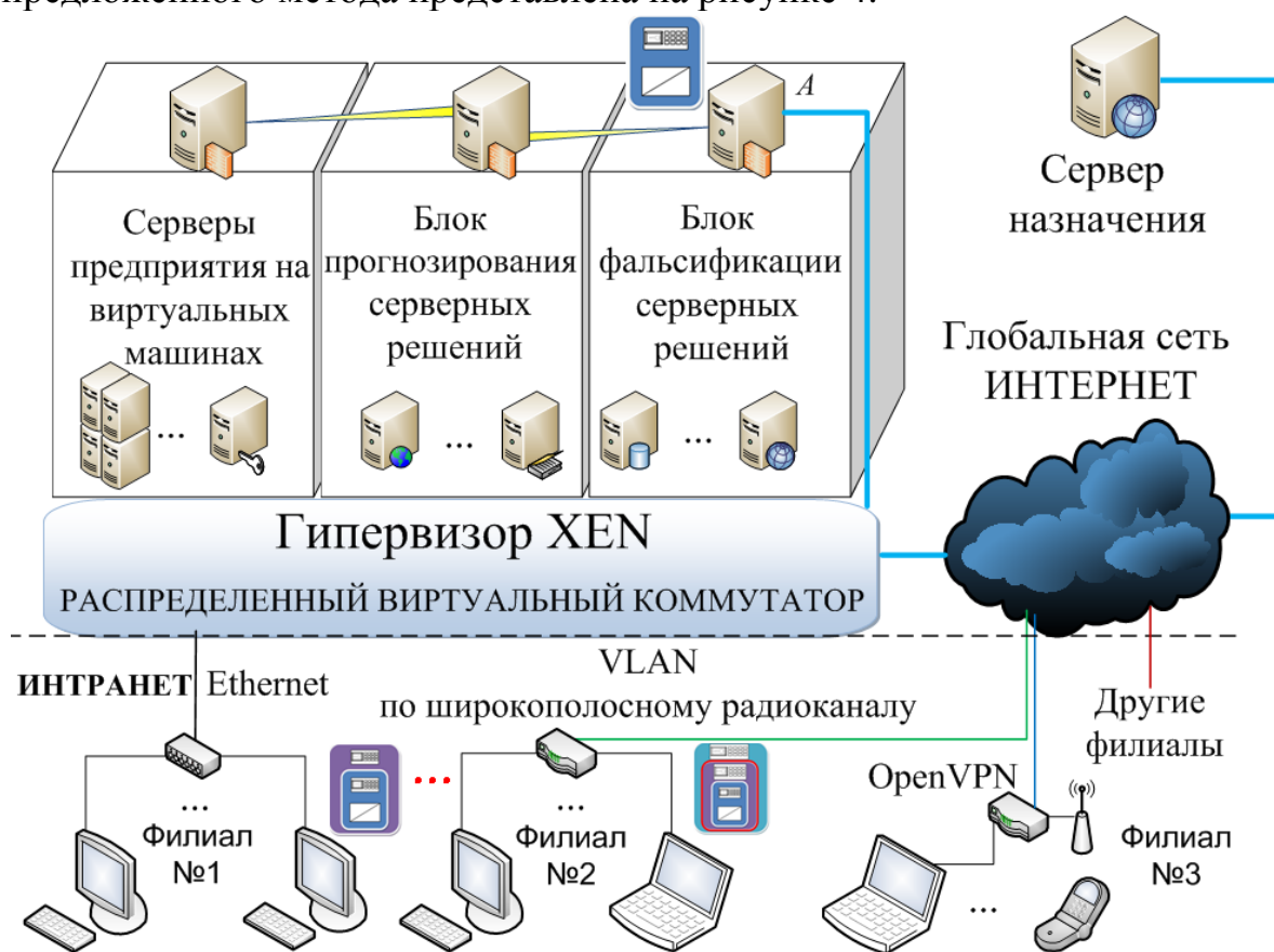
Рисунок 4 - Общая схема шифрования информационных потоков в корпоративной сети с использованием СИАУ
