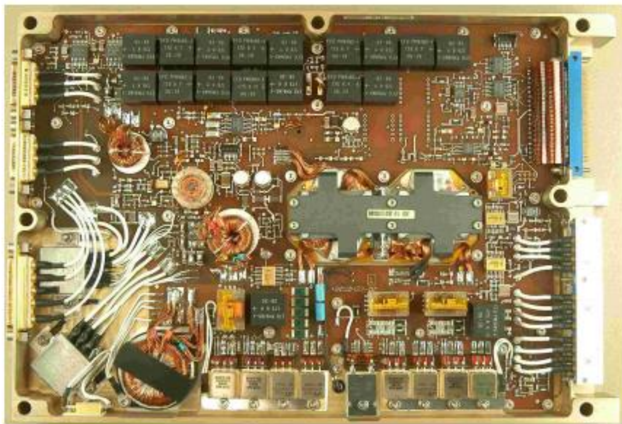
Рисунок 1.9 – Внешний вид силового модуля ЭПК платформы Alphasbus
