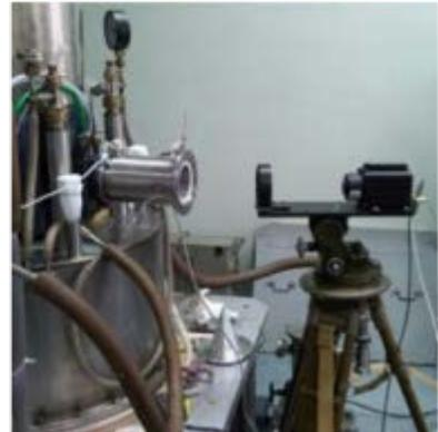
Рисунок 8.1.11 — Вид на газодинамическую ловушку в ИЯФ СО РАН (слева), где используются мощные пучки миллиметрового излучения, справа – вид на гиротрон (источник миллиметрового излучения) и установленными детекторами, смотрящими на выходное окно гиротрона
