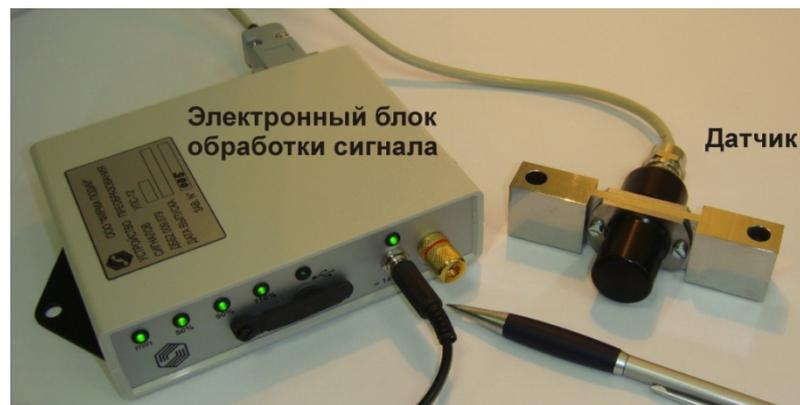
Рисунок 7.3.2 — Внешний вид устройства пьезооптических датчиков деформации серии УПС-10 (вверху) и УПС-12 (внизу)
