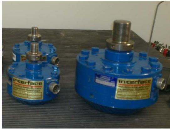
Калибровочные датчики Load Cell
