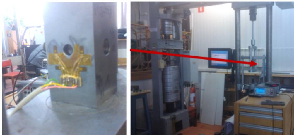
Рисунок 5.1.13 — Нагрузочный элемент с вставленным пьезооптическим преобразователем и с наклеенным тензорезистивным преобразователем (слева), и внешний вид испытательной машины с установленным нагрузочным элементом (справа).
