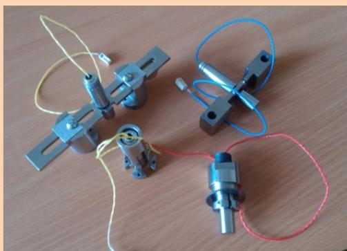
**Преобразователь с различными нагрузочными элементами**
