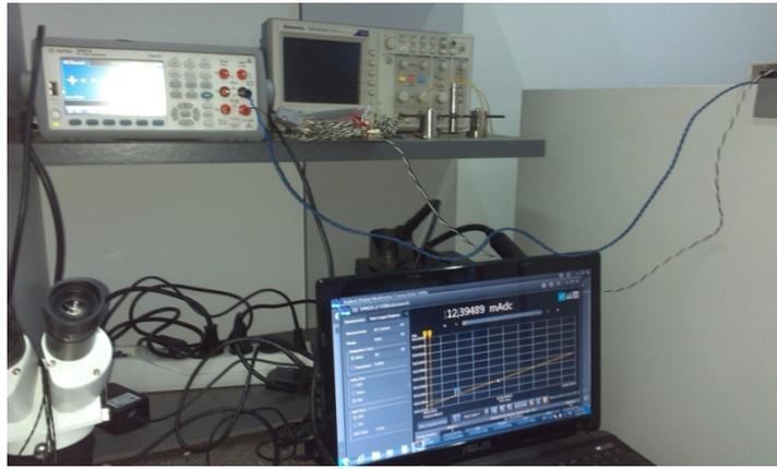
Рисунок 7.4.8 — Мультиметр и компьютер для сбора и записи данных.
