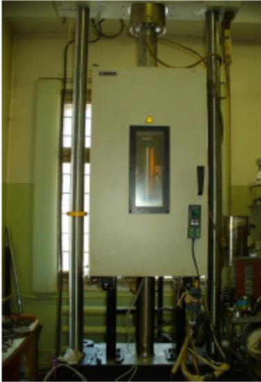
Рисунок 5 – Климатическая камера для измерения метрологических характеристик при повышенной температуре
