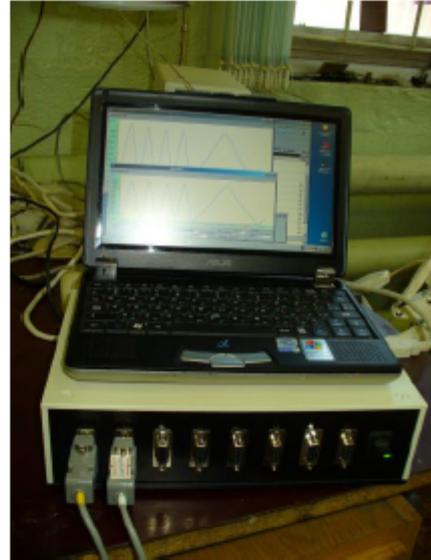
Рисунок 6 – 8-канальный вторичный преобразователь с ноутбуком для измерения временных характеристик сигнала с первичных преобразователей
