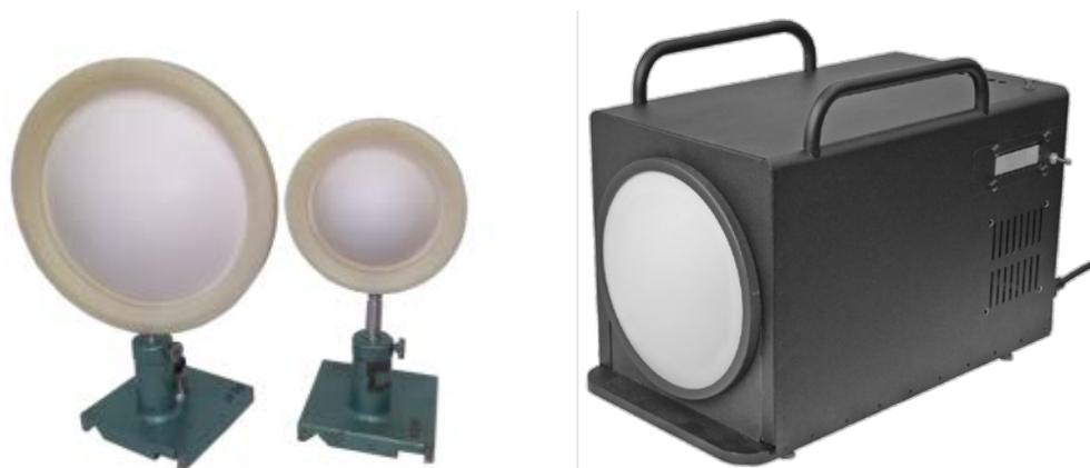
Рисунок 8.2.2 — Асферические линзы и источник 2-мм излучения
