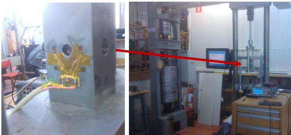
Рисунок 8.5.13 — Грузочный элемент с установленным пьезооптическим преобразователем и с наклеенным тензорезистивным преобразователем (слева), и внешний вид испытательной машины с установленным нагрузочным элементом (справа)
