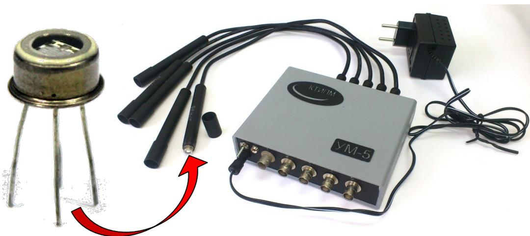
Рисунок 8.4.1 — Многоканальный пироэлектрический детектор УМК-5
