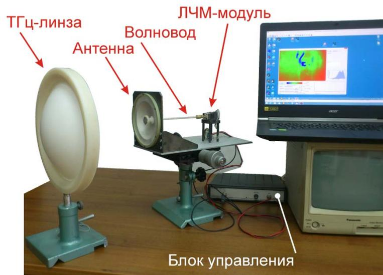
Рисунок 8.3.3 — СВЧ ЛЧМ-модуль с антенной, линзой и блоком управления
