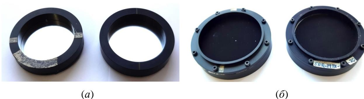
Рисунок 2.2.1 — Примеры конвертеров в оправе с рабочей апертурой  $50$  мм, *а* – со стороны поглощающего слоя (метапоглотителя), *б* – со стороны эмиссионного слоя
