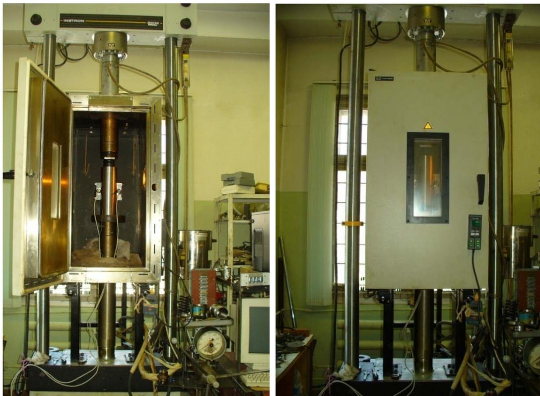
Рисунок 8.5.5 – Климатическая камера для измерения метрологических характеристик при разных температурах
