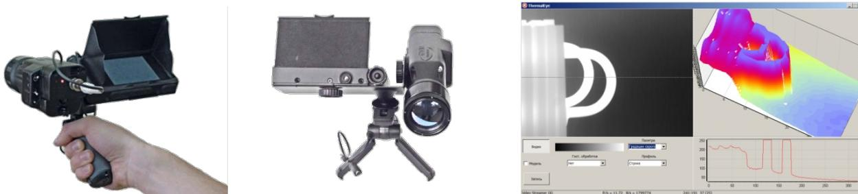
Рисунок 8.1.12 — Внешний вид ИК-камеры для регистрации теплового изображения поглотителя и тепловое изображение, полученное камерой
