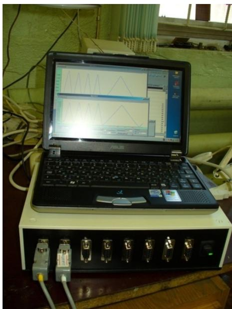
Рисунок 8.5.6 — Восемьканальный вторичный преобразователь с ноутбуком для измерения временных характеристик сигнала с первичных преобразователей
