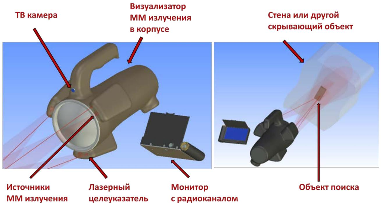
Рисунок 8.2.4 — Схема прототипа локального детектора скрытых объектов на основе ТГц-детектора
