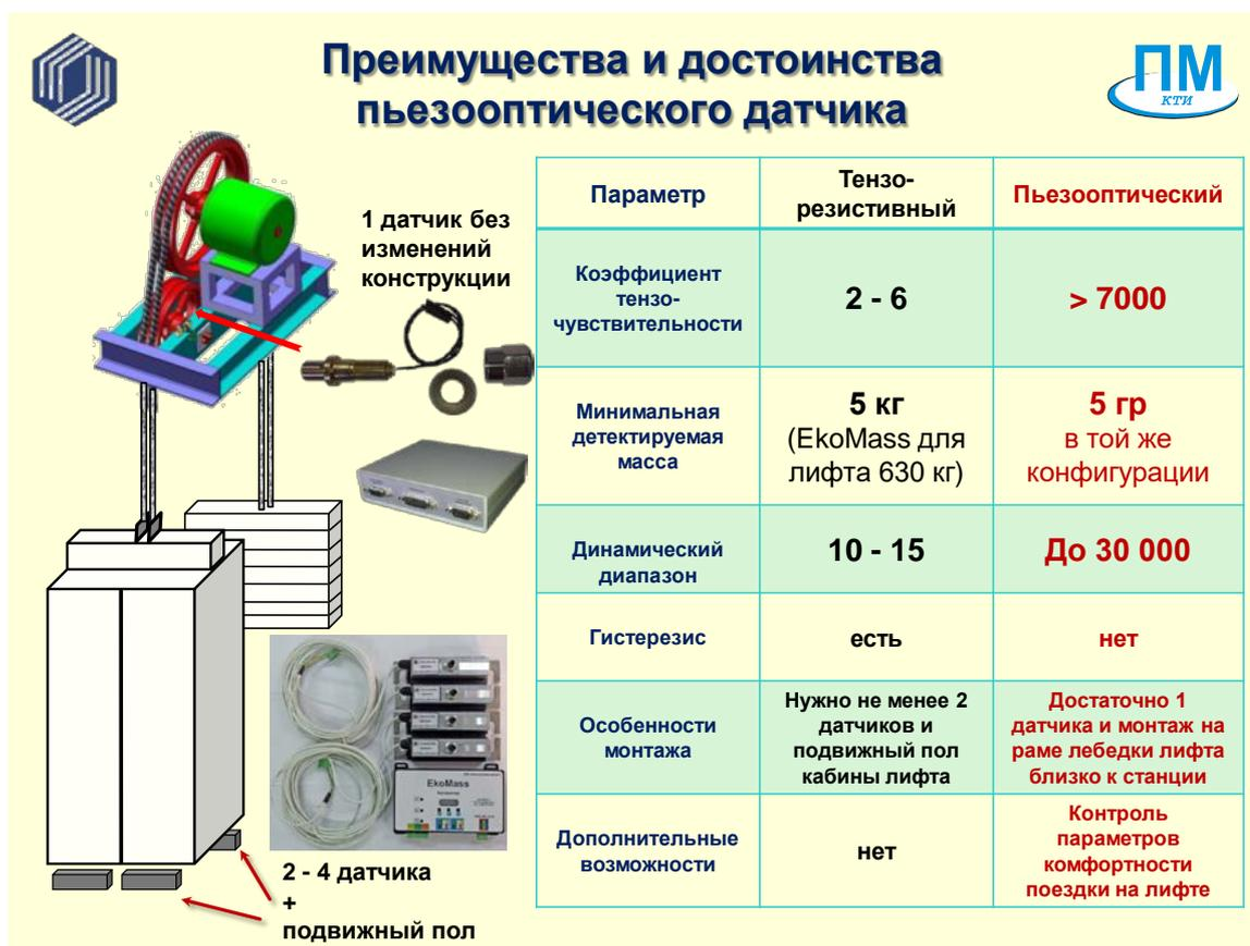
Рисунок 8.6.1 — Размещение пьезооптического датчика и тензорезистивных датчиков деформации на лифте и их параметры
