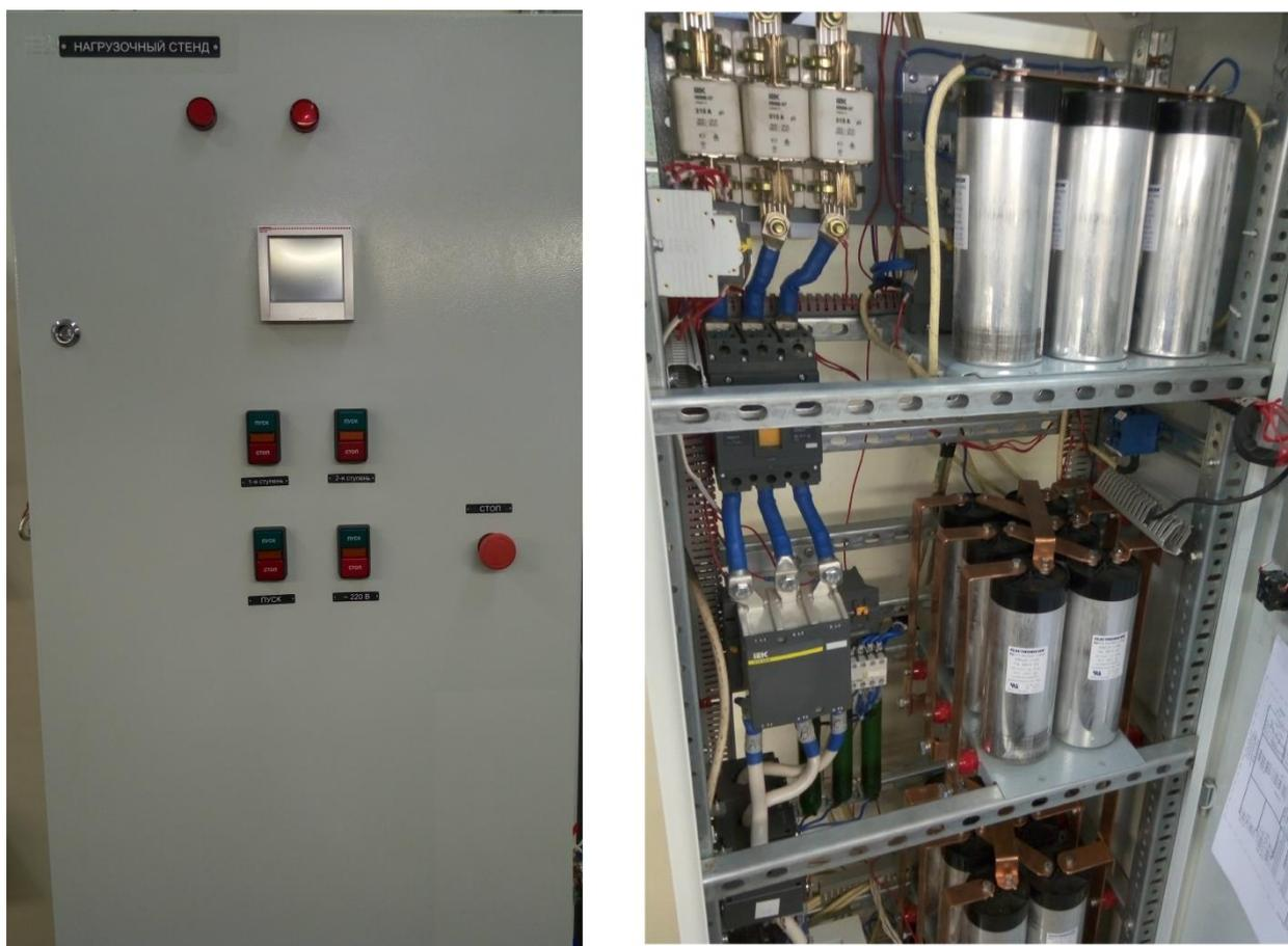
Рисунок 4.23 – Нагрузочный стенд, имитирующий режимы работы метрополитена
