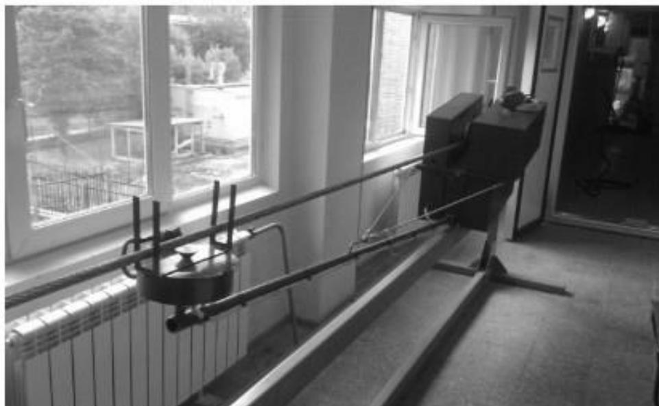
Рисунок 9 – Мобильная установка сбоя гололеда
