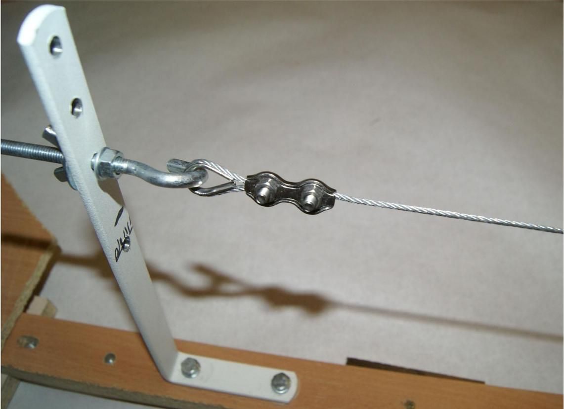
Рисунок 55 – Крепление провода к опоре
