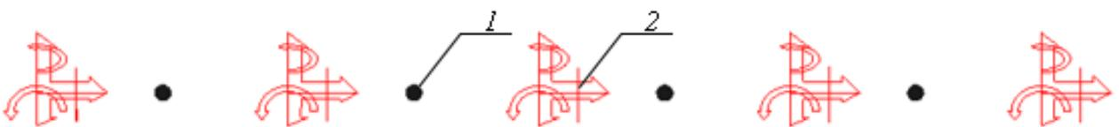
Рисунок 33 – Дискретная модель провода: 1 – элемент провода; 2 – упругое соединение
