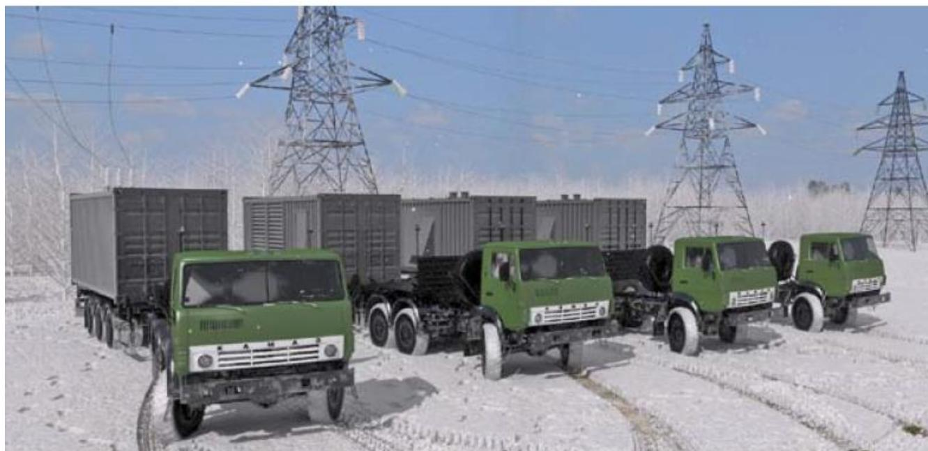
Рисунок 5 – Передвижные системы для плавки гололеда: а – автоконтейнеровоз УПГМ; б – установка МСУПГ
