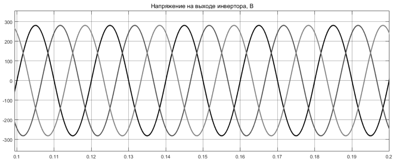
Рисунок 4.41 – Временные напряжения на вторичной обмотке трансформатора
