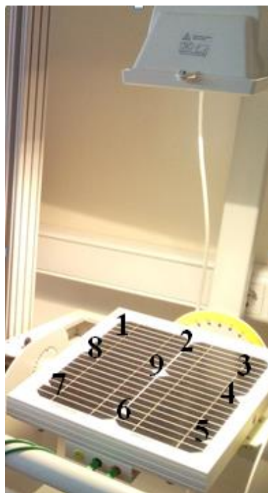
Рисунок 3.2 – Измерение освещенности по девяти точкам на солнечной батарее
