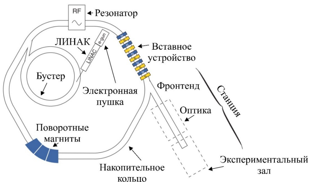
Рисунок 1.12 – Принципиальная схема устройства синхротрона [190]
