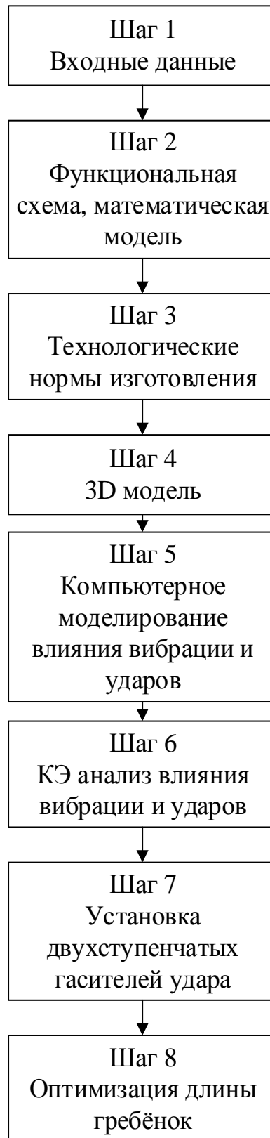
Рисунок 4.62 – Методика проектирования ММГ, устойчивого к механическим воздействиям
