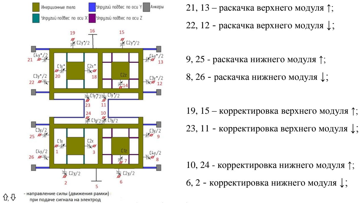
Рисунок 3.7– Электродная структура сенсора ММГ
