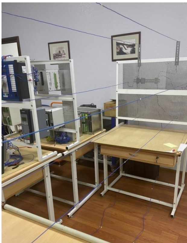
Рисунок 4.1 Стенд уменьшенной модели двухцепной ЛЭП
