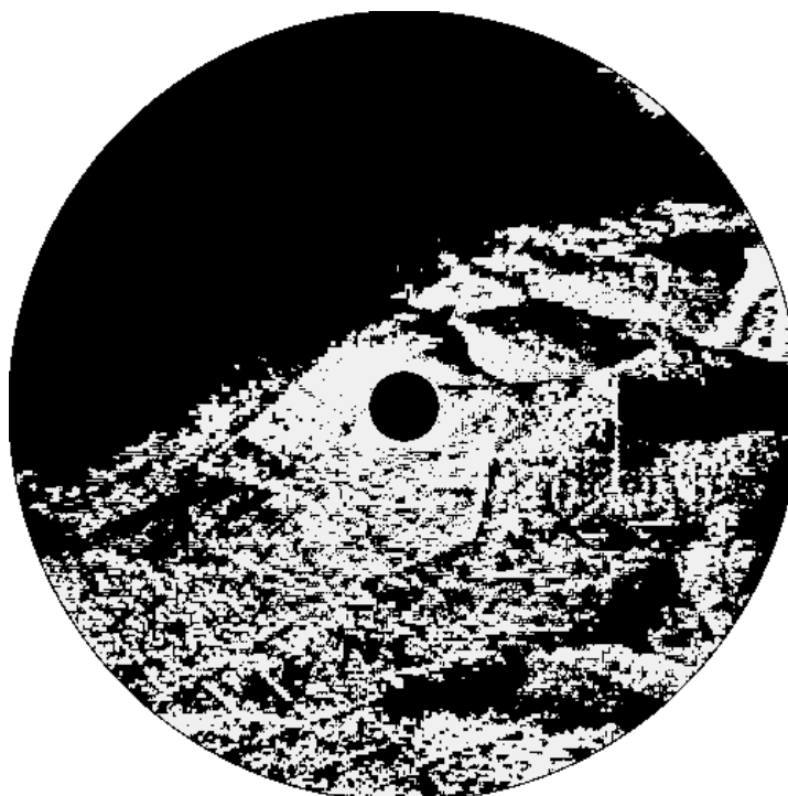
Рисунок 3.1 – Распределение УЭПР, полученное для реальной карты. Белым показаны участки, УЭПР которых выше -50 дБ
