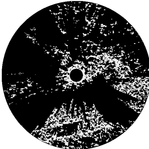
Рисунок 3.6 – Распределение УЭПР, полученное для реальной карты. Белым показаны участки, УЭПР которых выше -50 дБ
