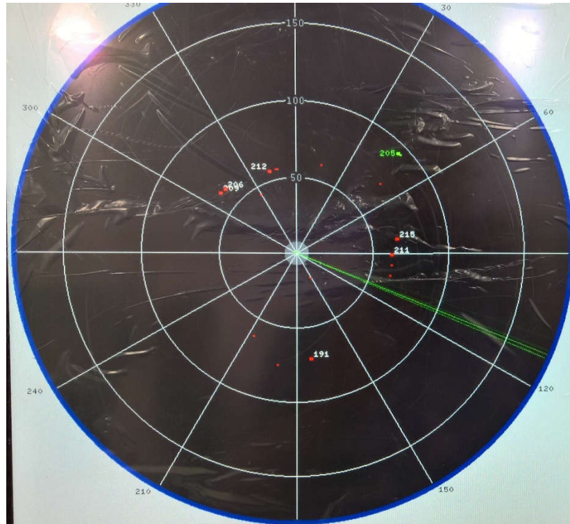
Рисунок 4.17 – Изображение на экране РЛС при включенной системе селекции движущихся целей
