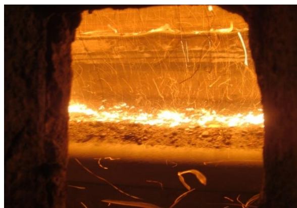
Рисунок 1.16 – Догорание провала на водоохлаждаемой дожигающей решетке
