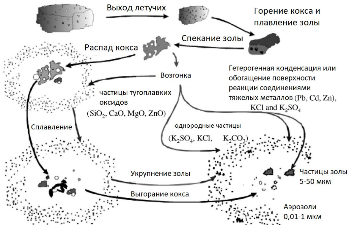
Рисунок 3.9 – Механизмы преобразования золы при сжигании топлива [115]
