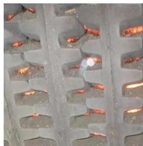
Рисунок 1.13 – Колосник двухстороннего воспламенения
