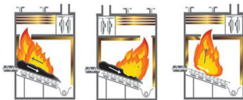
Рисунок 1.14 – Три схемы движения продуктов сгорания и слоя топлива, слева направо: противоток, прямоток и перекрестная [13]
