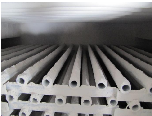
Рисунок 3.23 – Макет шахматного трубного пучка в экономайзере
