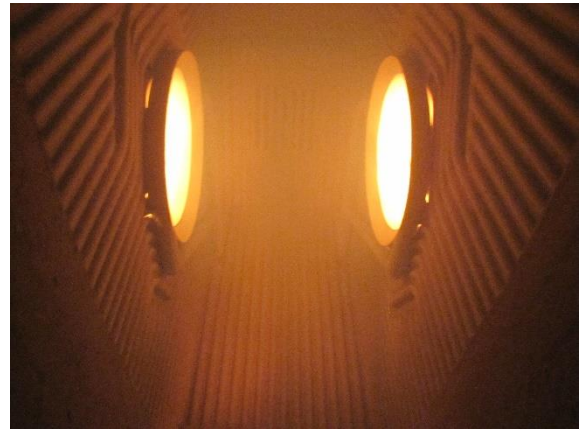
Рисунок 2.38 – Вид отложений и пламени из ГОО: слева – котел Е-16 с вихревой топкой и двухкамерным сжиганием; справа – Е-14 с вихревой топкой «Торнадо»
