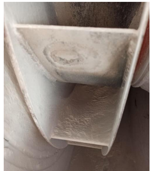
Рисунок 3.29 – Золовые отложения на тыльной стороне лопаток дымососа ДН-12,5
