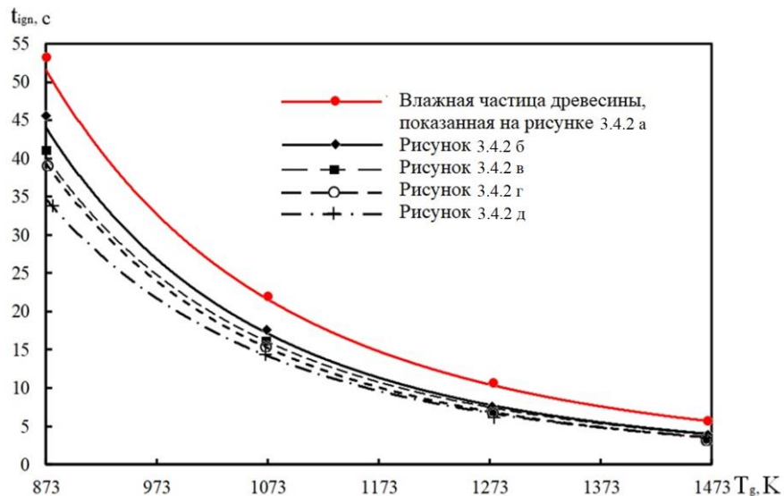
Рисунок 3.4.4 – Зависимость времен задержки зажигания частиц древесной биомассы в зависимости от температуры внешней среды в условия фрагментации приповерхностного слоя топлива [157]
