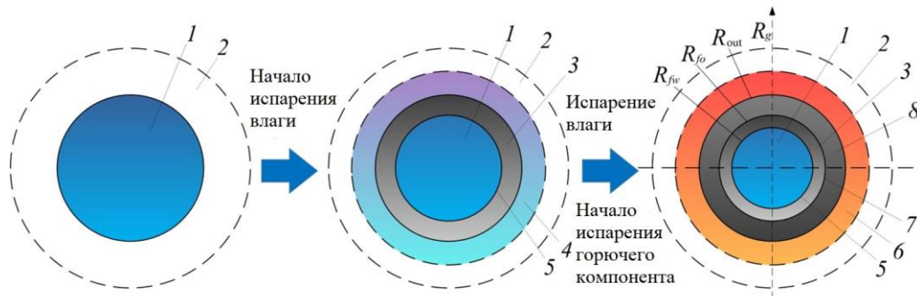
Рисунок 4.2.3.4 — Схема области решения задачи зажигания [172]: 1 – исходное топливо, 2 – разогретый воздух, 3 – смесь КЕКа и масла, 4 – область диффузии горючих газов и водяных паров, 5 – фронт испарения воды, 6 – область газофазного зажигания, 7 – фронт испарения масла, 8 – сухой уголь
