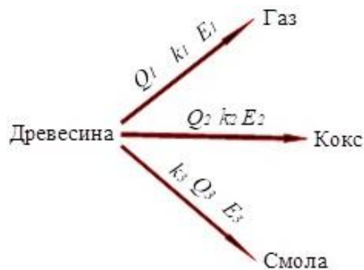
Рисунок 3.3.2 — Одностадийная схема пиролиза с параллельным образованием трех продуктов реакции [408, 178]
