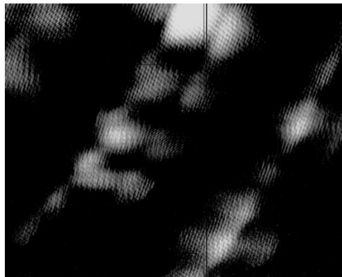
Рисунок 4.4 – Изображение интерференционной картины при фокусном расстоянии камерного объектива 2 м.
