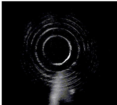
Рисунок 4.1 – Изображение интерференционной картины при фокусном расстоянии камерного объектива 50 мм.
