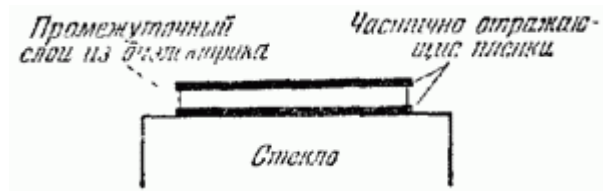
Рисунок 1.3 – Интерференционный фильтр типа Фабри – Перо
