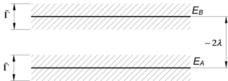
Рисунок 2.7 — Условное обозначение резонансных уровней энергии системы и их ширины
