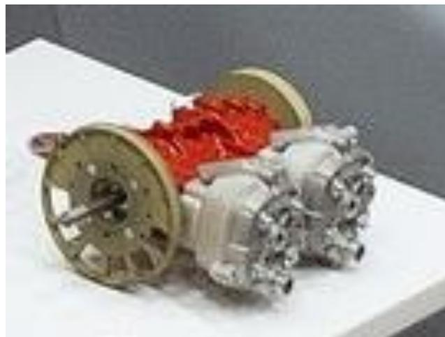
Подготовка силового модуля для испытания совместно с мотор-генератором
