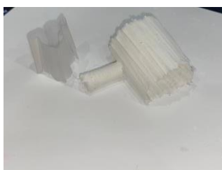
Рисунок 2 – а) «Намотанный» сосуд, половина коллектора снята, б) готовые прототипы сосудов
