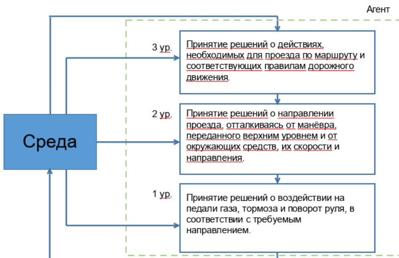
Рисунок 1 – Схема обмена информацией между уровнями предложенного алгоритма
