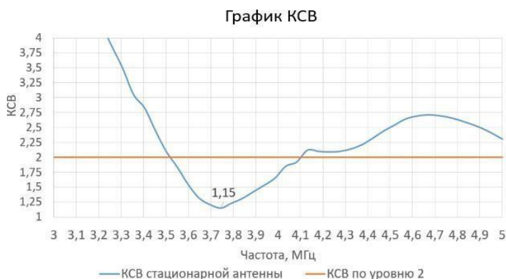
Рисунок 2 — Экспериментальный замер КСВ стационарной антенны
