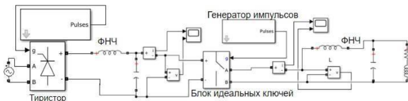
Рисунок 2 – Модель преобразователя напряжения
