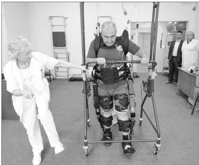
Экзоскелет появился в центре с самого его открытия. Вес оборудования – приблизительно 400 килограммов, а чтобы его надеть или снять, требуется около получаса. Сейчас с ним тренируется Константин Баранов. /ФОТО: СВЕТЛАНА ФРОЛОВА
