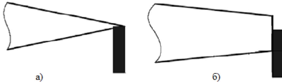
Рисунок 3.10 – Геометрия устройств: а) закрылок Гурни; б) MiTE
