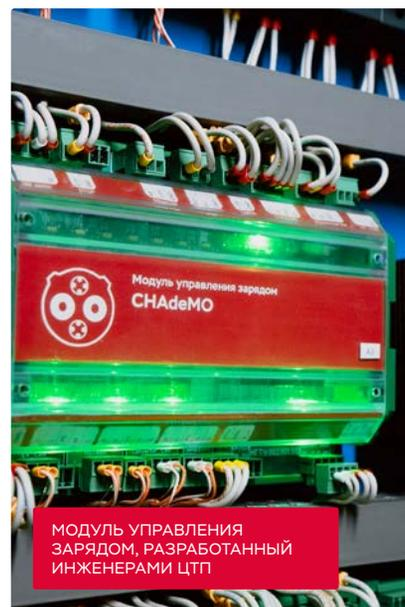
МОДУЛЬ УПРАВЛЕНИЯ ЗАРЯДОМ, РАЗРАБОТАННЫЙ ИНЖЕНЕРАМИ ЦТП
