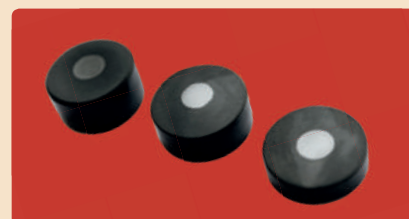
Образцы керамики на основе карбида бора
