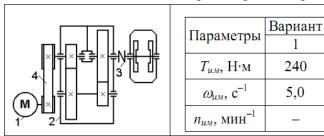
1 — электродвигатель, 2 — редуктор, 3 — муфта, 4 — ременная передача.  $T_{u_M}$  — крутящий момент на валу исполнительного механизма,  $\omega_{u_M}$  — угловая скорость вращения исполнительного механизма,  $n_{u_M}$  — частота вращения исполнительного механизма.
